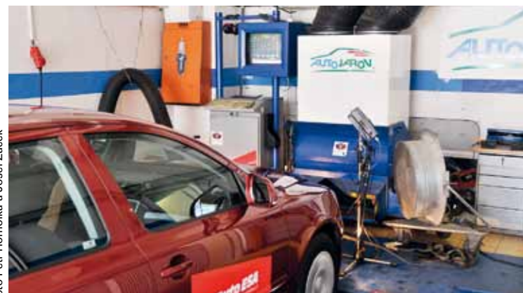
Začali jsme měřením výkonu se standardní neaditivovanou motorovou naftou v nádrži
