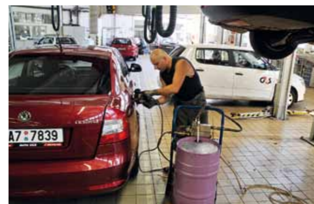
Poté jsme nechali odsát zbytek nafty z nádrže. V palivovém systému zůstaly maximálně tři litry nafty.
