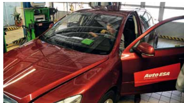
Poté jsme změřili kouřivost. Výrobce udává součinitel absorpce 1,0 l/m, stanice měření emisí pracují s nejistotou 0,5, takže limit je 1,50 l/m. Naměřili jsme 1,02 l/m.
